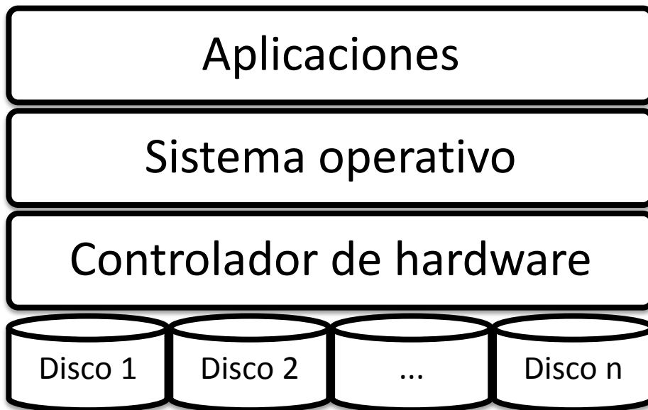
Figura 2. Esquema de una RAID por hardware
