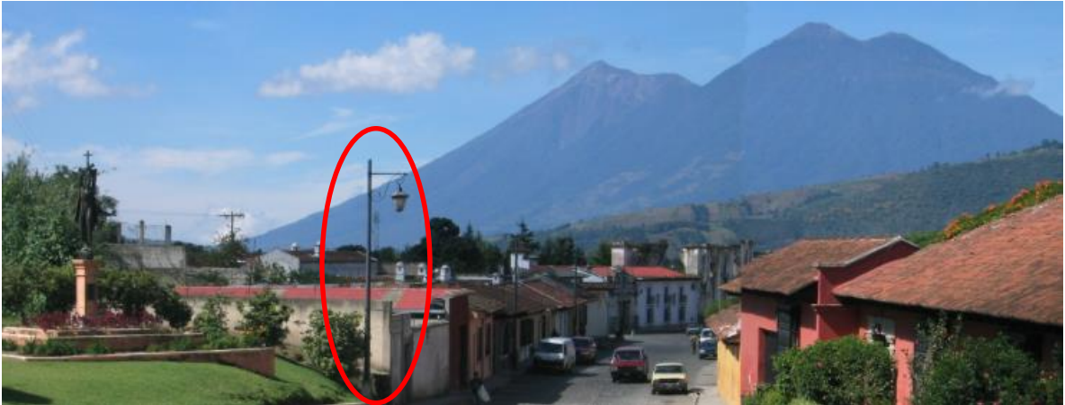
Figura 20. Antena de radiofrecuencia mimetizada como farol
