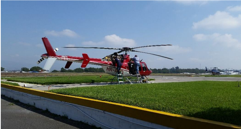
Figura 26. Inspección de mantenimiento preventivo diario
