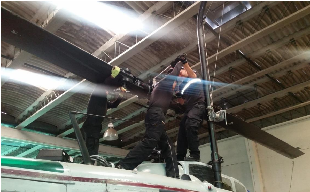
Figura 35. Procedimiento empírico, remoción turca del mástil
