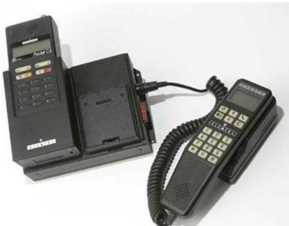
Figura 3. Estación base sistema Radiocom 2000
