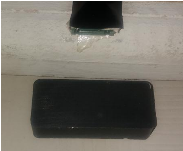
Figura 60. Imán y Reed Switch en posición adecuada
