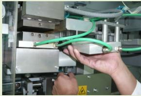
Limpiar y sanitizar las guías que se encuentran después de la estación de sellado, utilizando wipe x-80 con el sanitizante en rotación, luego colocar las guías
