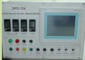
Ajustar el paso de la maquinaria para los nuevos moldes y realizar pruebas de sellado y temperatura (ajuste de temperatura en el panel de control), la temperatura varía según los formatos.
