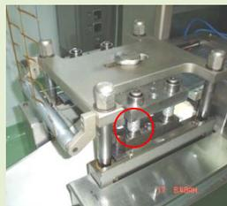
Revisar los resortes de troquel de corte. Si los resortes presentaran algún, daño se reemplazan. Nota: los resortes tienen que ser del mismo calibre y resistencia para no afectar el funcionamiento del troquel de corte.
