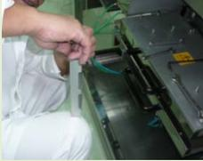
Revisar las mangueras de agua y aire comprimido, revisar que no existan fugas. De existir; arreglar fugas con la ayuda de personal de mantenimiento.
