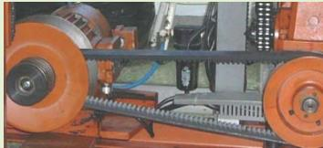
Revisar si existe desgaste de la faja dentada (si presenta desgaste, realizar el cambio de la misma).
