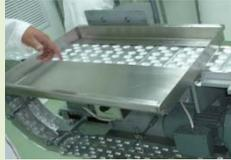
Limpiar la bandeja de distribución de producto utilizando wipe X-80 con agua desmineralizada y sanitizar con paños húmedos con el desinfectante de rotación.
