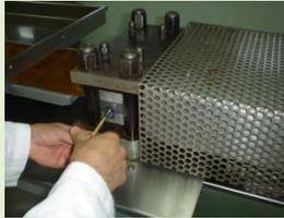
En caso de cambiar de molde en la estación de formado, remover el molde anterior utilizando llave hexagonal de 4 mm y los tornillos que sujetan el molde a la plancha de formado con llave de corona de 1/2" y colocar el nuevo molde.
