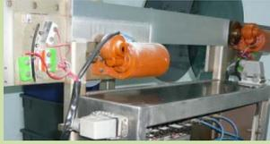
Revisar y limpiar el motor de la bobina de aluminio.
