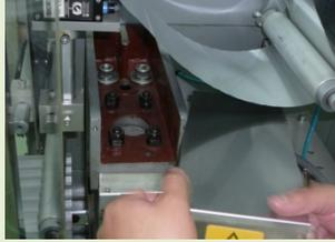
Remover la plancha de sellado, limpiar y sanitizar utilizando wipe x-80 con el sanitizante en rotación (cambiar la plancha de sellado si se cambia a un nuevo lote de producción). Volver a instalar la plancha de sellado (revisar el estado de roldanas).
