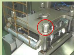
Remover las tuercas utilizando llave de cola No. 32 y se saca la plancha de la base del troquel de corte. Posteriormente, se desarman las 2 planchas de corte y se engrasan (se utiliza grasa alimenticia).
