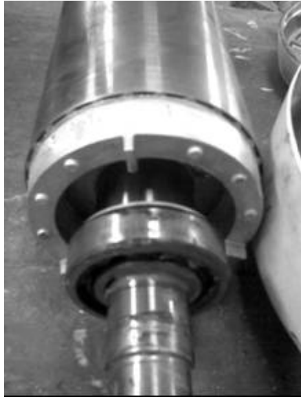
Figura 54. Eje con rodamientos en mal estado
