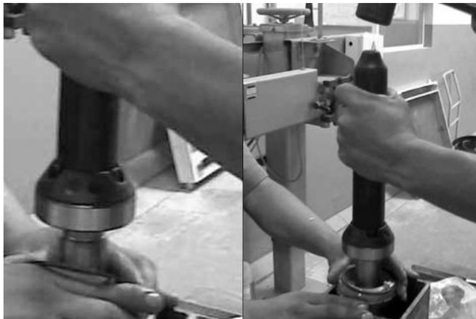
Figura 57. Montaje de cojinete con herramienta de golpe
