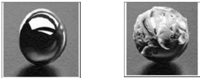
Figura 22. Balero mal ajustado y balero con exceso de grasa
