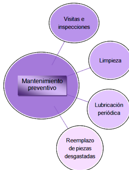
Figura 16. Componentes de un adecuado servicio de mantenimiento
