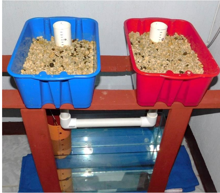
Figura 83. Contenedores con piedra pómez
