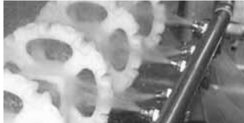
Figura 10. Pulverizadores del sistema de limpieza incorporado
