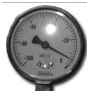
Figura 2. Manómetro con escala negativa (Escala en pulgadas de agua)
