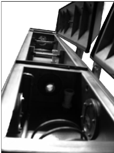
Figura 3. Compartimientos de la recámara de vacío.
