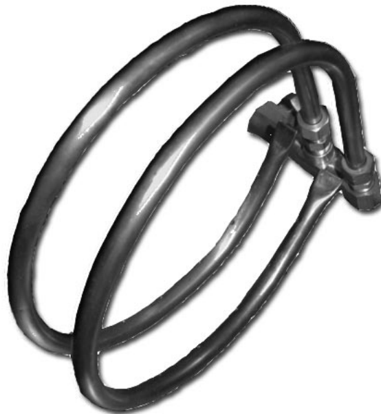
Figura 5. Sistema de tubos de cobre para secar el perfil.
