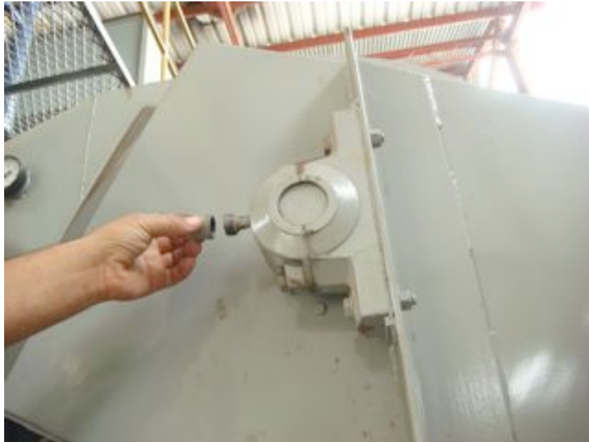
Figura 50 Sistema de lubricación diaria de chumaceras
