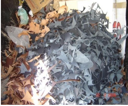
Desechos sólidos producto del proceso de troquelado
