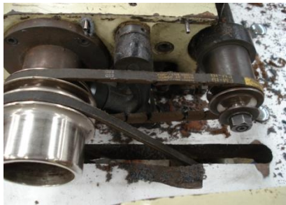
Faja de máquina de costura en mal estado
