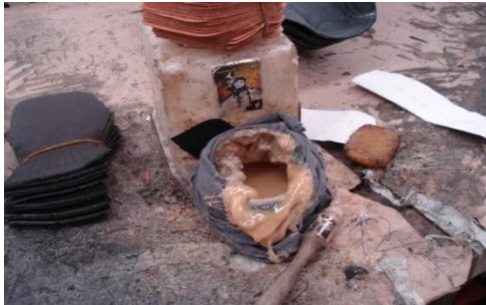
Dispensador de pegamento en mal estado
