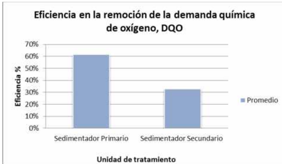
Figura 29. Eficiencia del sistema de tratamiento en la remoción de la demanda química de oxígeno, DQO
