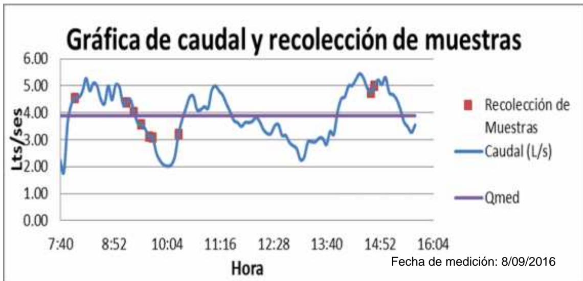
Figura 19. Variación del caudal de agua residual que ingresa a la PTAR de la USAC
