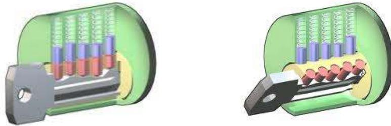
Los pernos están alineados y alcanzan la línea de corte. Permite la rotación del cilindro
