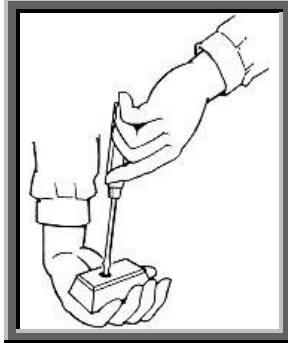
Figura 12. Forma incorrecta de atornillar
