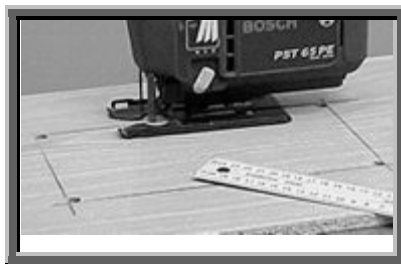
Figura 66. Corte de una ventana
