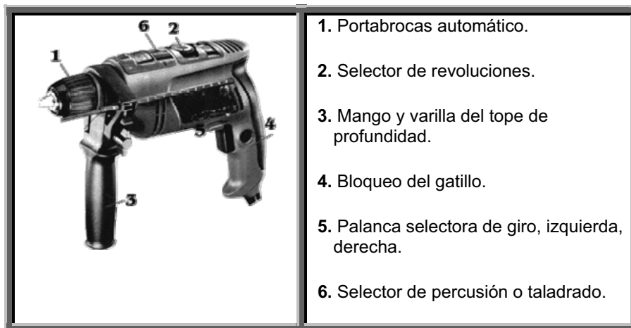
Figura 22. Partes del taladro eléctrico portátil
