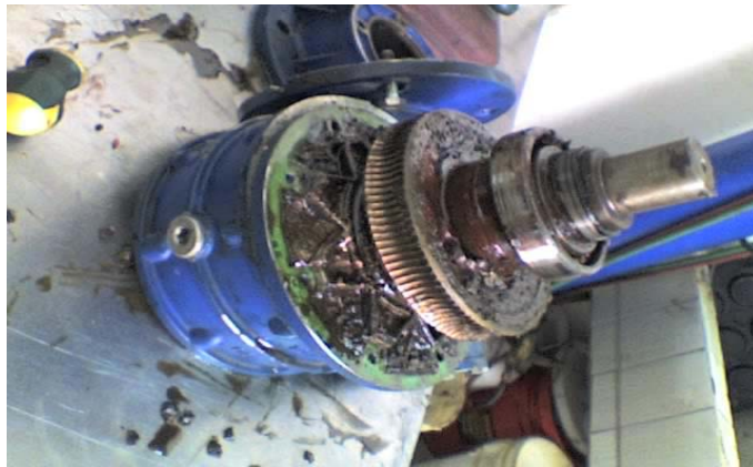
Figura 8. Cojinete en mal estado caja reductora horno Zucchelli.
