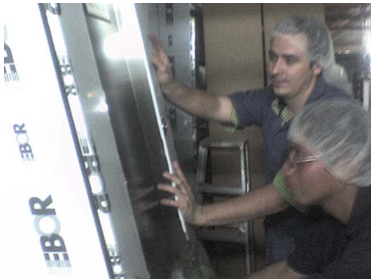
Figura 12. Armado de paneles laterales horno Werner.
