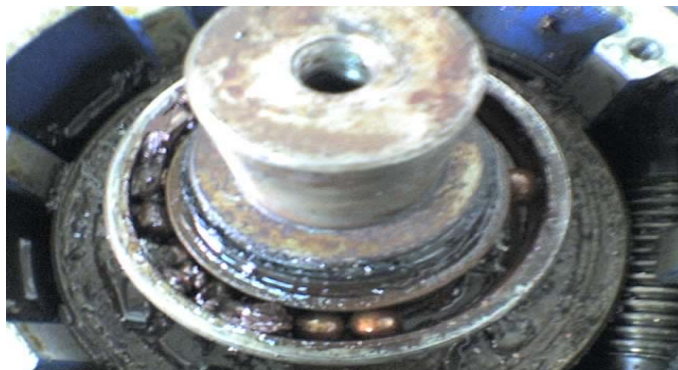
Figura 8. Cojinete en mal estado caja reductora horno Zucchelli.
