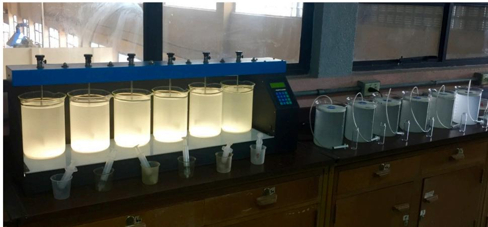
Dosificación de solución coagulante por medio de jeringas. A la derecha toma de muestras para la respectiva medición de turbiedad.
