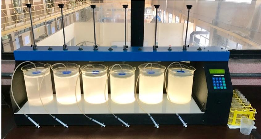
Muestras tomadas por medio de jeringas y flotador con sifón invertido.
