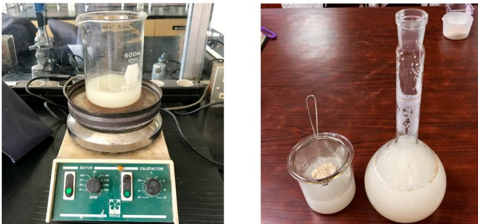
Izquierda: mezclador magnético utilizado. Derecha: solución utilizada al 1 %
