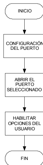
FIGURA 14: Diagrama de flujo del procedimiento ABRIR CONEXIÓN
