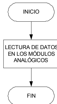
FIGURA 25: Diagrama de flujo módulo LECTURA DE DATOS ANALÓGICOS
