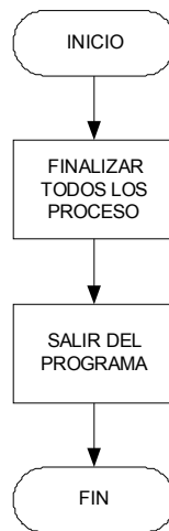
FIGURA 16: Diagrama de flujo del procedimiento SALIDA.
