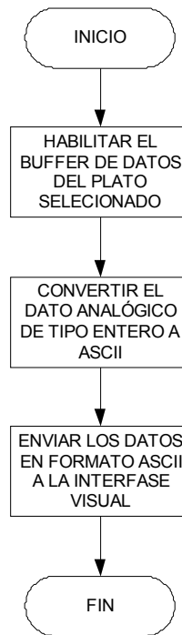
FIGURA 24: Diagrama de flujo del módulo SALIDA DE DATOS
