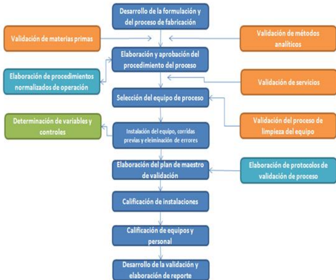
Figura 5. Diagrama de flujo de la validación general de un proceso para una forma farmacéutica sólida
