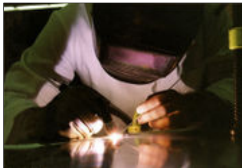
Figura 46. Soldando con arco de tungsteno
