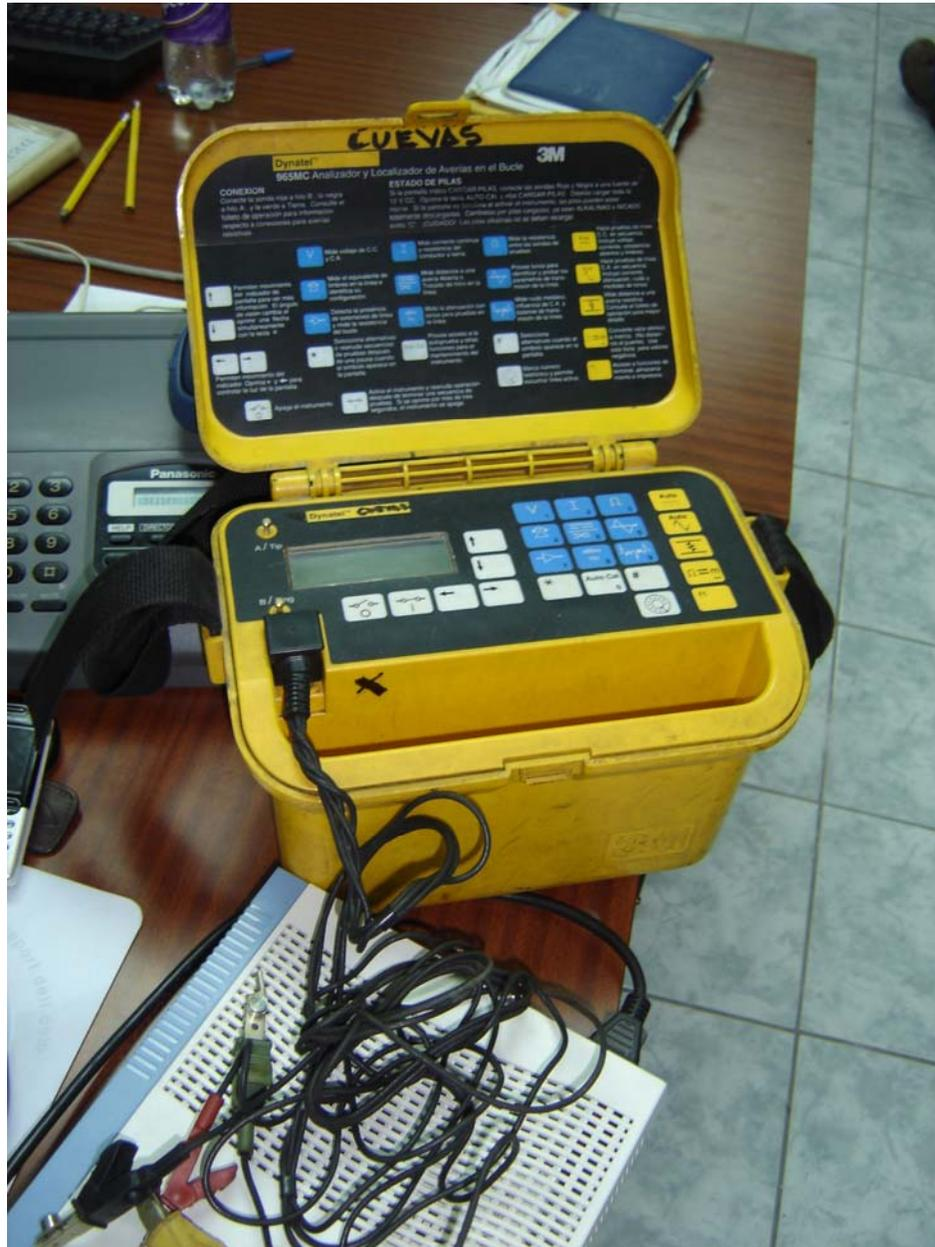
Equipo Dynatel utilizado para las mediciones del Cobre, con este se verifica el aislamiento, e inductancias en los pares de cobre.
