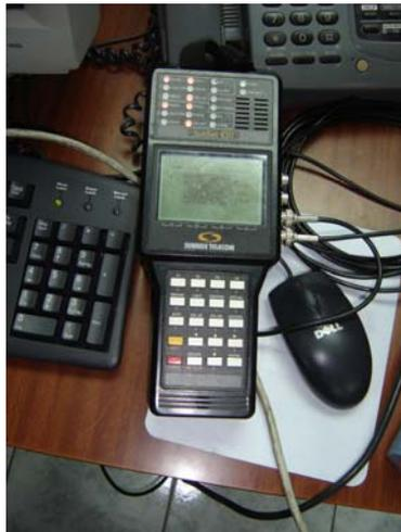
Este equipo SunSet E10 es el mas antiguo utilizado, aparte de utilizarse para el chequeo de la transmisión para los servicios también tiene la capacidad de funcionar como simulador de planta telefónica pero únicamente en servicios con señalización ISDN.
