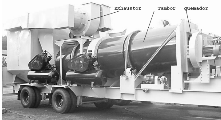
Figura. 5: Vista exterior de un tambor secador-mezclador.
