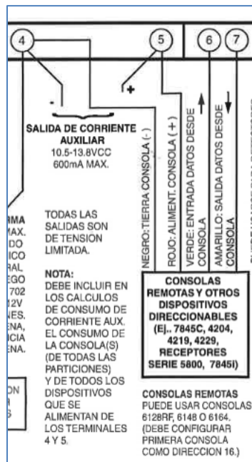
Figura 80. Terminales para conectar módulo de relé para el control de acceso
