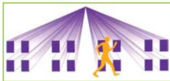
Figura 37. Patrón de detección tecnología cuatro sensores piroeléctricos
