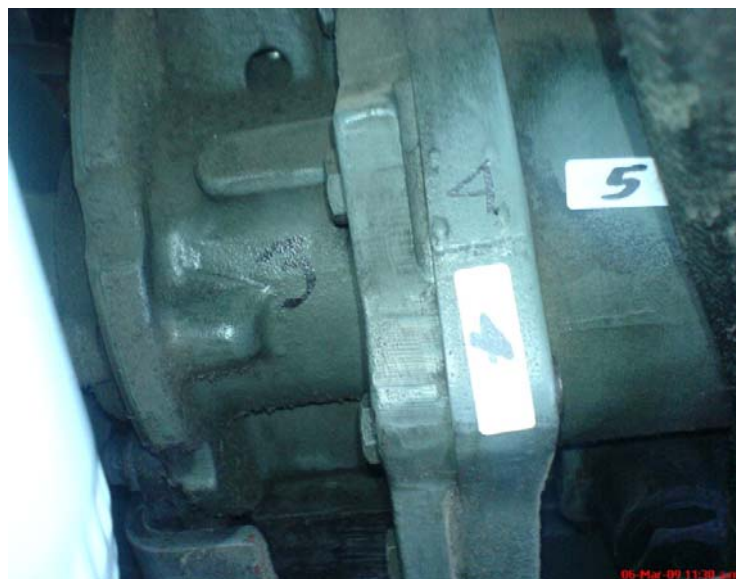
Figura 64. Puntos de medición de ultrasonido de contacto en unidad compresora de tornillo
