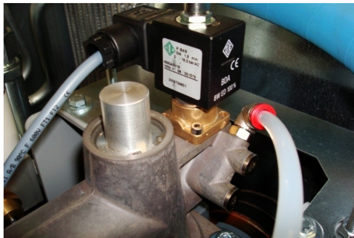
Figura 43: Vista de válvula solenoide controlado la apertura de válvula de admisión (diseño europeo).
