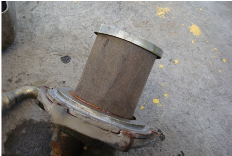
Figura 61: Vista externa de separador de aceite usado
