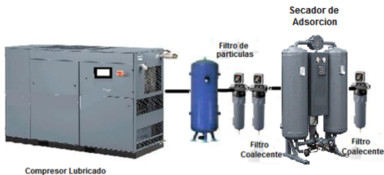
Figura 94: Instalación compresor lubricado + tanque + filtro de partículas + filtro coalescente + secador de adsorción + filtro coalescente
