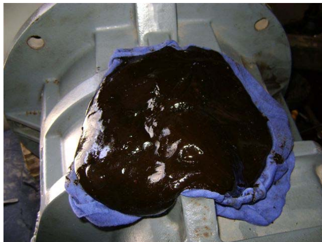
Figura 54. Mezcla gelatinosa de aceites extraída del acople motor-unidad,
