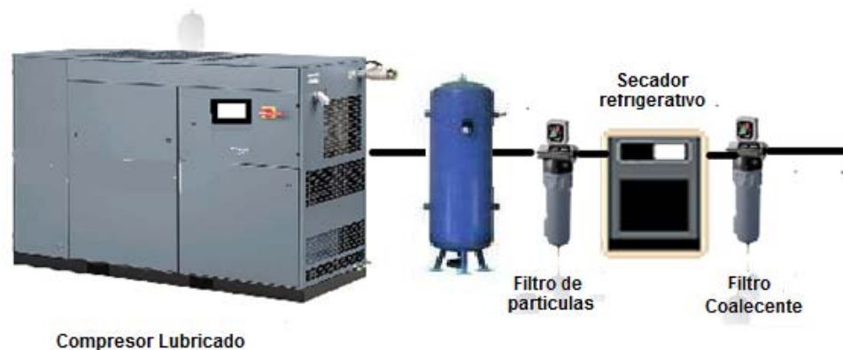
Figura 91. Instalación compresor lubricado + tanque + filtro de partículas + secador frigorífico + filtro Coalescente encontrada en la mayoría de industrias
