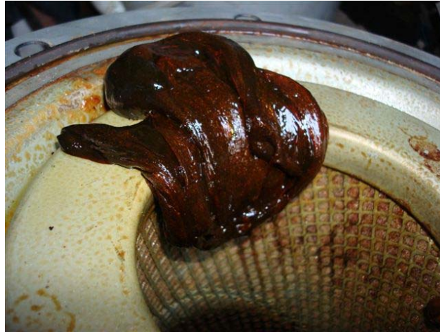
Figura 55. Mezcla gelatinosa de aceite extraída del filtro separador de aceite
