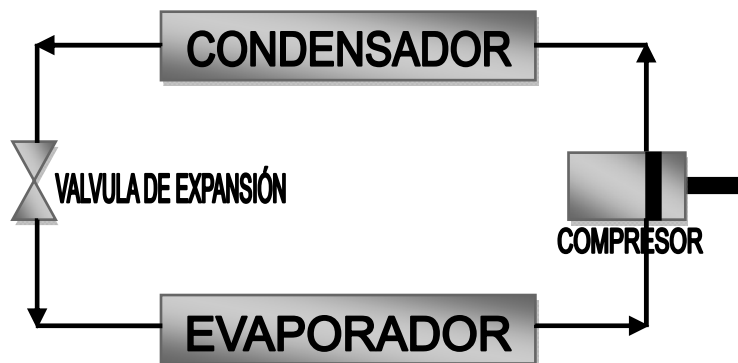
Figura 1. Sistema de refrigeración convencional.
