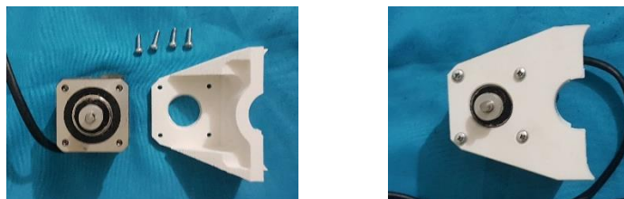
Figura 23. Colocacion base de motor paso a paso
