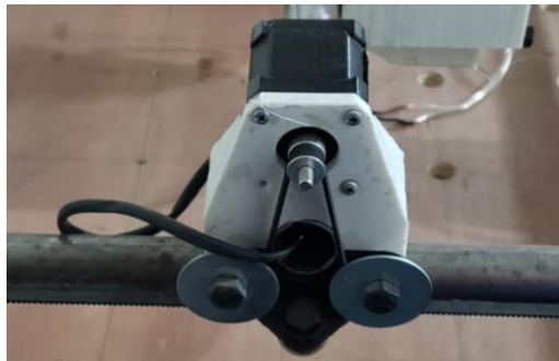
Figura 32. Colocación de correas y cinchos plásticos
