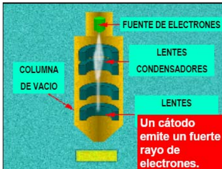
Figura 53. Columna del microscopio electrónico de barrido
