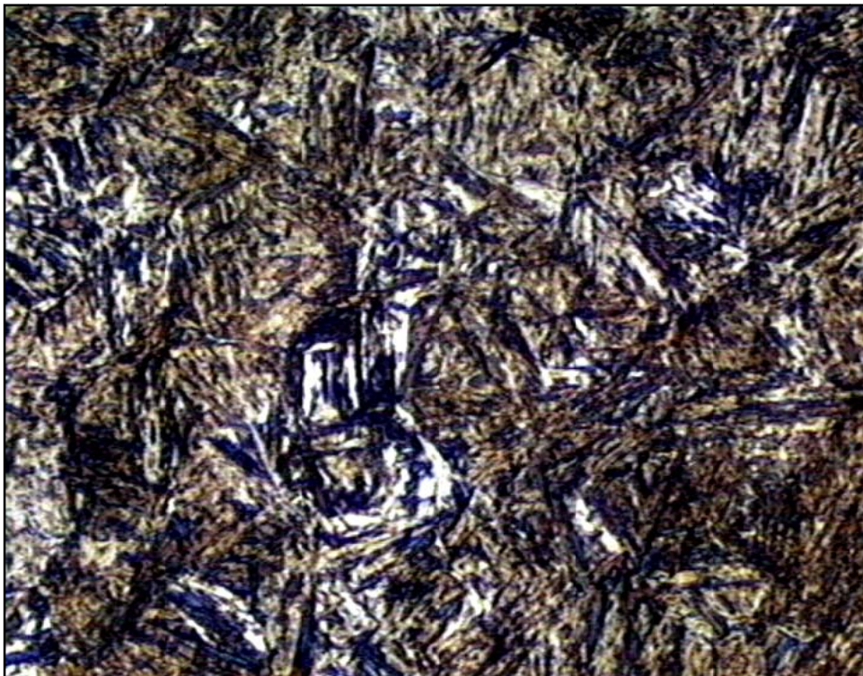
Figura 40. Estructura de un acero templado con 0.35% de C (400x)
