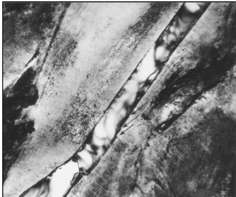
Figura 9. Cementita en acero SAE 52100 transformado a 810 0 C (40,000x)
