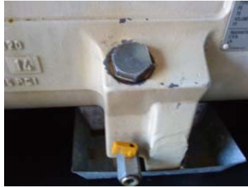
Figura 35: Punto de lubricación del compresor de aire
