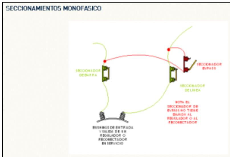
Figura 34. Muestra el bypass activado, por lo tanto la unidad reguladora está fuera de servicio
