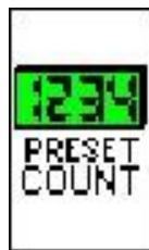
Figura 105. Función de contador progresivo/regresivo con preselección
