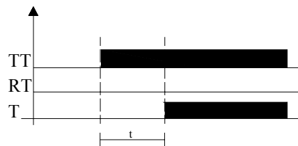
Figura 32. Forma en que opera el timer trabajo, comando mantenido
