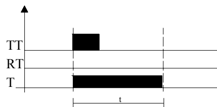
Figura 36. Forma en que responde el timer Cambio, en flanco ascendente
