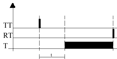
Figura 33. Forma en que opera el timer trabajo, salida/parada por impulso
