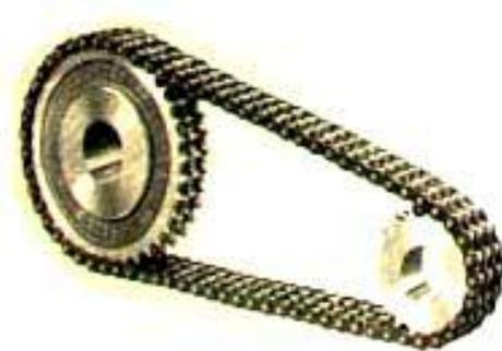
La transmisión de potencia entre la cadena y la rueda se efectúa por un acoplamiento de forma y de fuerza entre los dientes de las ruedas (sprockets) y los eslabones de la cadena. Esta, es adapta a la rueda en forma de polígono, esto produce pequeñas fluctuaciones en el brazo de la fuerza periférica y por consiguiente, también en la velocidad de la cadena y en la fuerza de la misma, llamado efecto de polígono.
