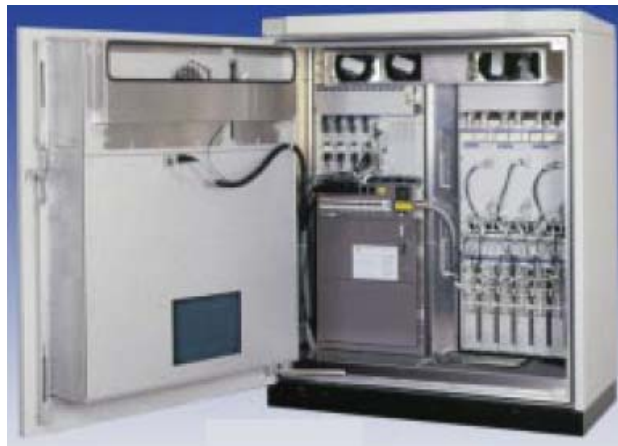
Figura 16. Radio base modelo 2106.
