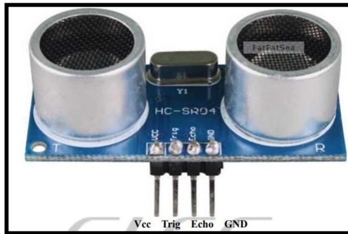
Fuente: Introduction to Arduino Nano. *Conexiones de módulo HC-SR04*.
