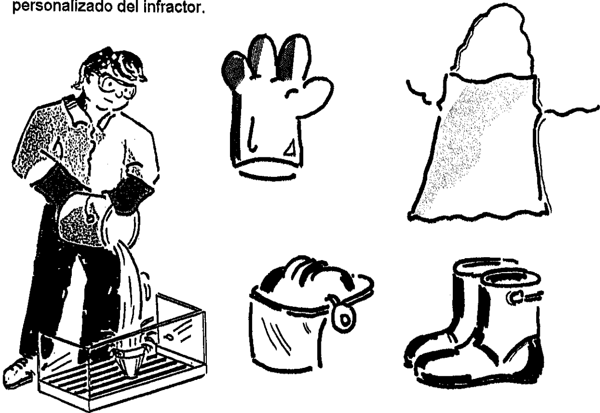
Fig. 1.3.a. Muestra a un trabajador de productos químicos, con todo su equipo de protección personal (guantes, ropa, careta, calzado especial). Además se observan algunos implementos de equipo de protección personal que pueden utilizarse, acordes a la tarea.
