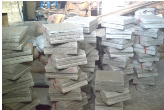
Figura 12. Piezas de piso hacia el área de pulido, en el área de secado
