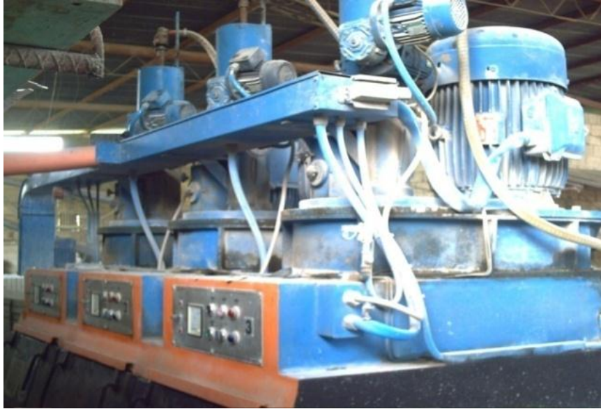
Figura 32. Pulidora de piezas de piso en la planta de producción
