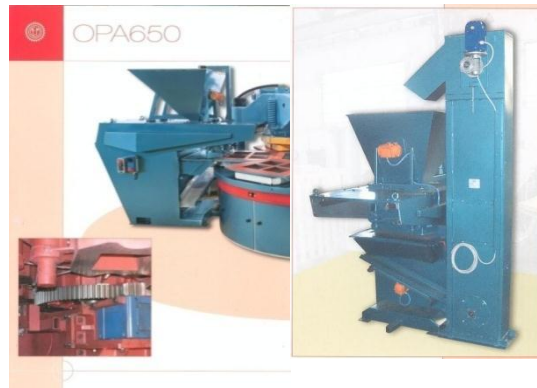
Figura 6. Tren planetario con engranes cilíndricos utilizado para dar giro al conjunto de mesa y molde
