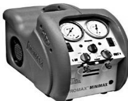
Figura 18. Equipo de recuperación eléctrico.
