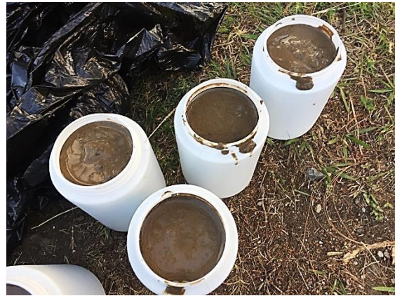
Fotografía 2. Lodos de puntos distribuidos para muestra compuesta.
