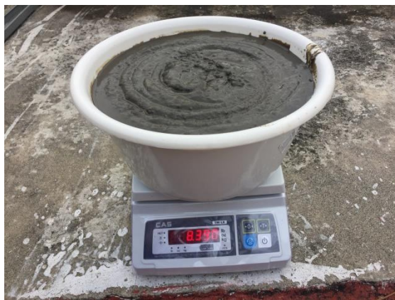
Fotografía 13. Inicio del monitoreo de la deshidratación de los lodos
