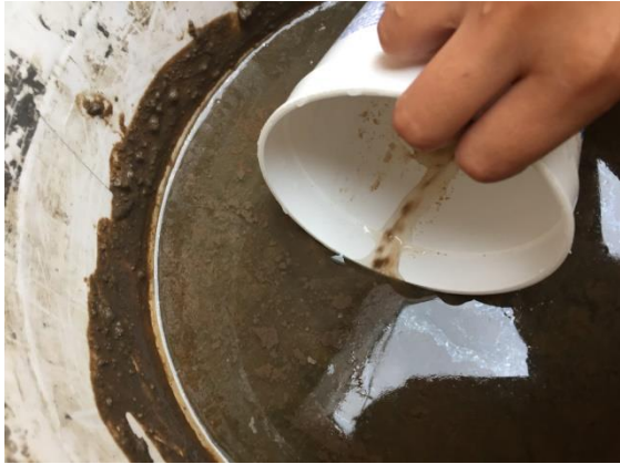
Fotografía 5. Retiro capa sobrenadante de agua sobre lodos espesados.
