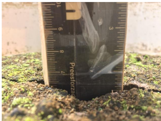
Fotografía 20. Finaliza monitoreo de altura en la capa de lodos
