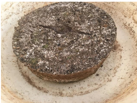
Fotografía 19. Finaliza monitoreo de la deshidratación de los lodos
