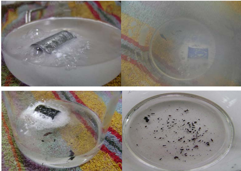
Figura 62. Reacción de la probeta de aluminio en la solución utilizada para el proceso de pulido químico
