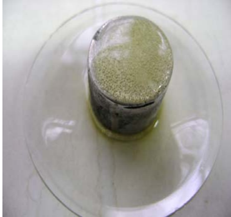
Figura 70. Probeta de aluminio colado en arena al momento de ser sometida al proceso de ataque químico
