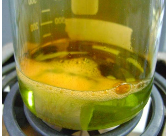
Figura 64. Desprendimiento de oxido de nitrógeno de la reacción entre la probeta de cobre y la solución de pulido químico
