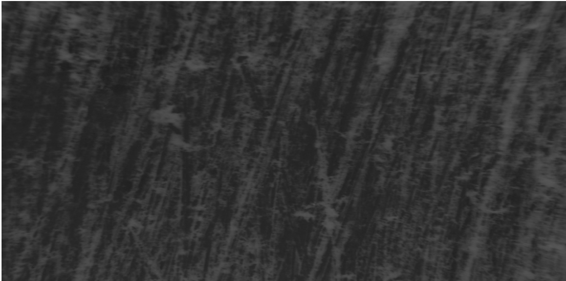
Figura 40. Fotomicrografía de probeta de Al con abrasivo # 180 pulido manual
