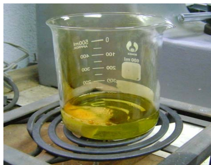
Figura 63. Reacción de la probeta de cobre en la solución utilizada para el pulido químico
