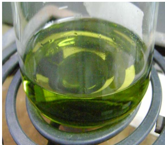
Figura 65. Solución producto del pulido químico de la probeta de cobre, de color verde por la presencia de iones níquel; en medio ácido
