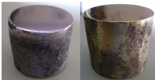
Figura 36. Probetas de Al y Cu colado en arena
