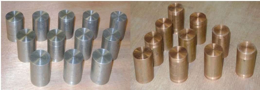
Figura 35. Probetas de Al y Cu colado en coquilla
