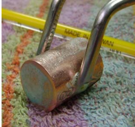
Figura 66. Probeta de cobre después de ser sometida al proceso de pulido químico
