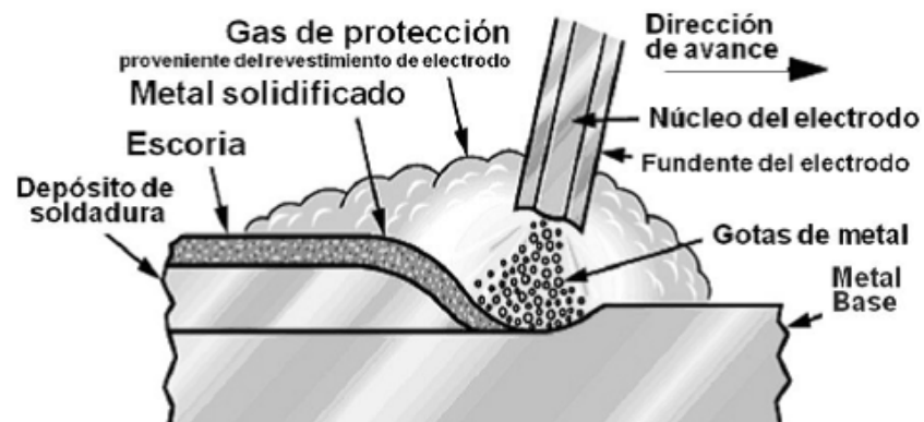
Figura 9. Soldadura al arco
