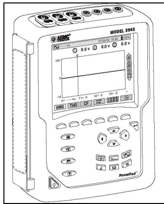
Figura 2: Analizador de calidad de energía power pad Modelo 3945.
