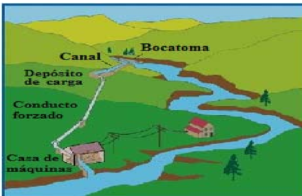
Figura 6. Vista aérea de una micro hidroeléctrica
