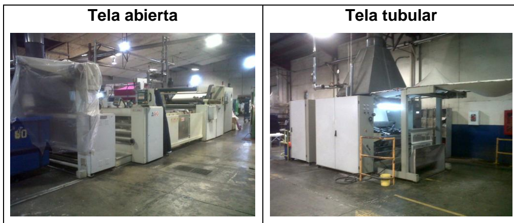
Figura 6. Máquinas de compactado
