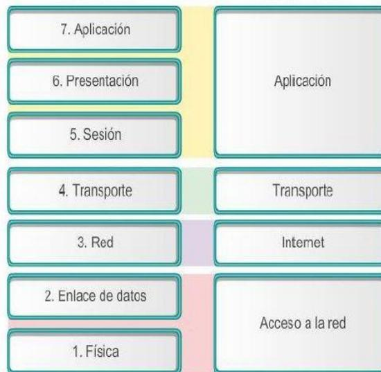
Fuente: Ingenieria Systems. *Comparación entre modelo OSI y modelo TCP/IP.*
