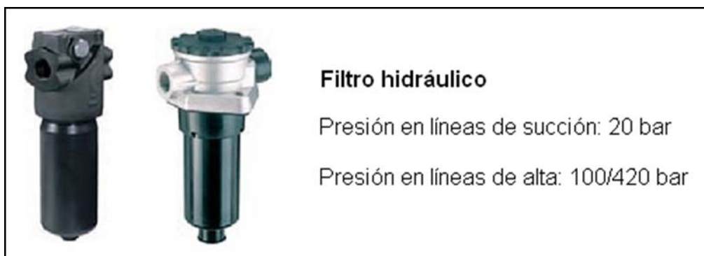
Figura 26. Filtro hidráulico
