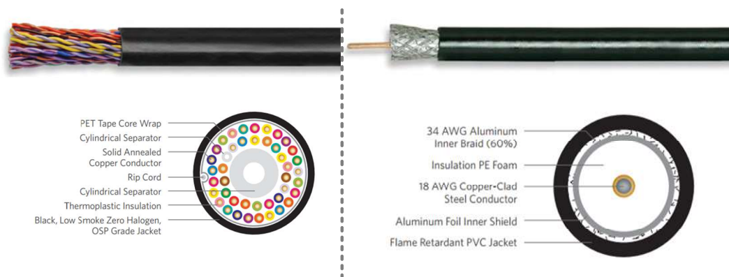
Figura 2. Cables de cobre en par trenzado y en construcción coaxial
