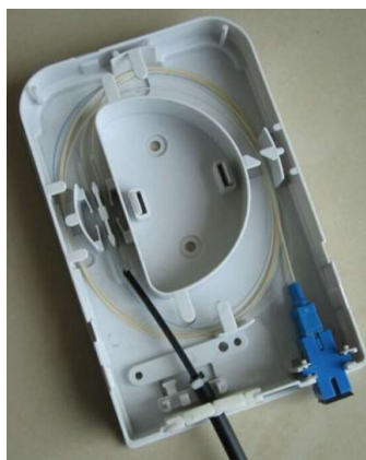
Figura 19. Caja terminal con un pigtail SC/UPC fusionado y conectado
