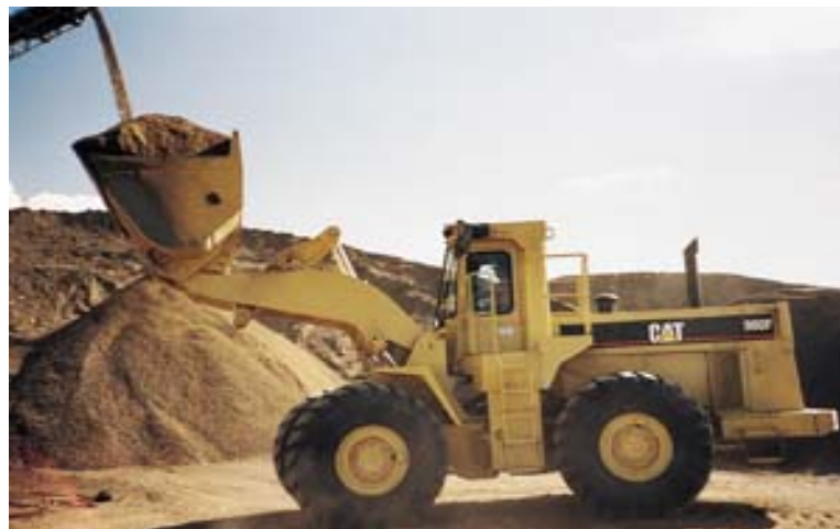
Figura 15. Cucharón para arena y grava.
