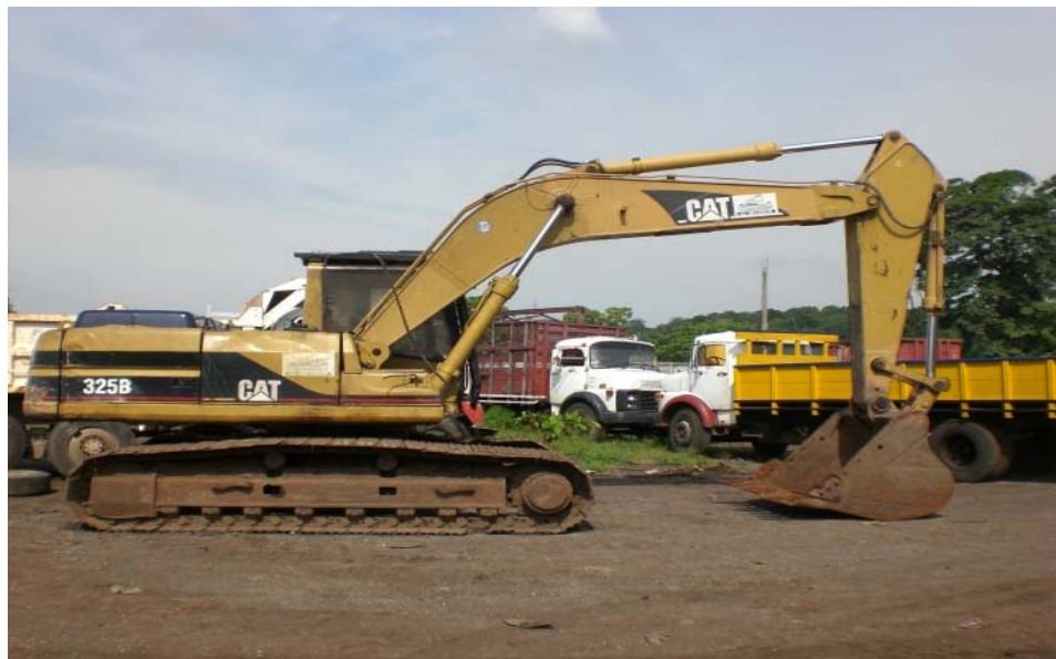
Figura 34. Excavadora Caterpillar 325 B.
