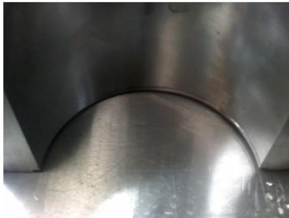
4. Diseño para la cajuela de inserto de rosca y cajuela de guillotina, este consiste en dejar un área en la salida del cuello del envase, el cual será trabajado después en el área de torno y fresa para poder dar la forma necesaria a la salida del molde.
