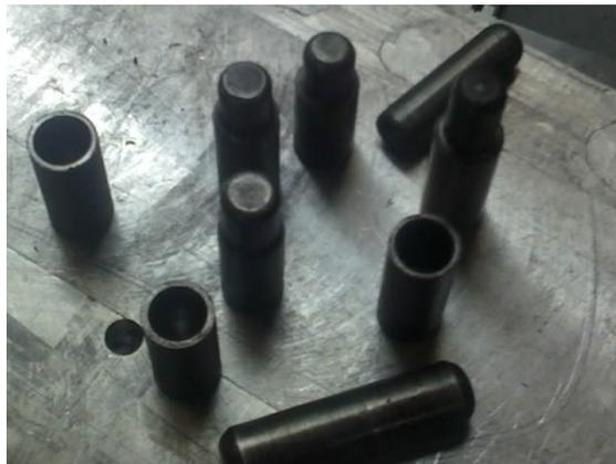
6. Cortadores, se fabrican en el área superior e inferior de la cavidad en el molde donde se tendrá presencia del macarrón, los cortadores cumplen la doble función de enfriar y la de cortar los excesos de material, se fabrican en la fresa.
