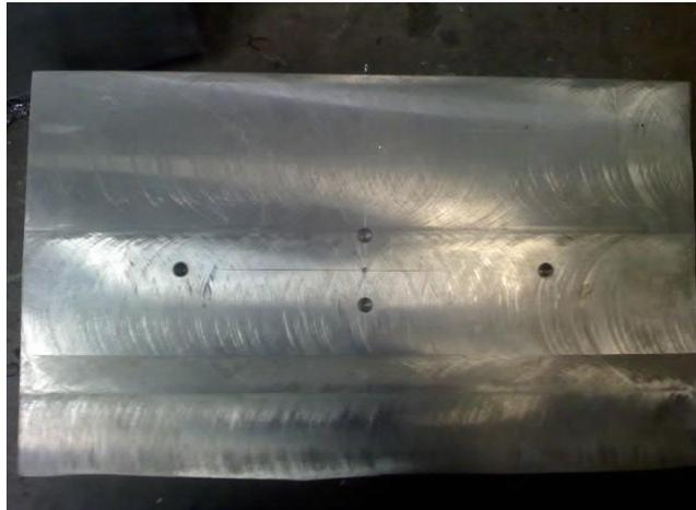
Contando con la pieza de material de las medidas deseadas, y con los agujeros listos se procede a montar la plancha de aluminio en la placa sujetadora montada en el CNC.
