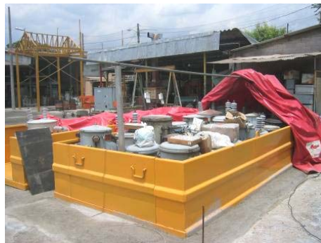
Figura 51 Cajas metálicas para embalaje de carcasas.
