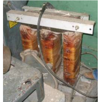
Figura 8 Núcleo y devanado de un trafo
