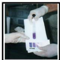
Ejemplo de prueba negativa con CLOR-N-OIL: color oscuro.
