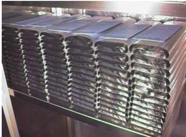
Figura 14. Núcleo de un capacitor de potencia
