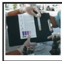
Ejemplo de prueba positiva con CLOR-N-OIL: color claro.
