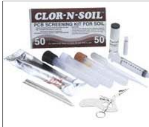
Figura 36. Kit Clor-N-Soil, para determinar concentración de PCB en suelos sospechosos de estar contaminados.
