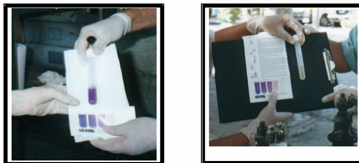
Figura 35: Resultados de análisis clorhídrico con kits CLOR-N-OILS.
